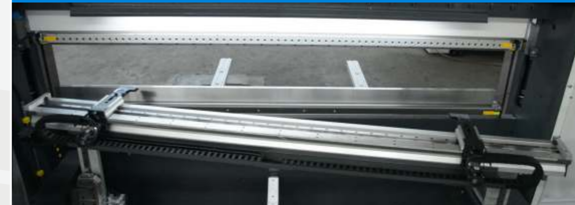
X1 X2 R Z1 Z2 (Servo motorized)
